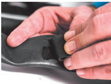
Мал. 34.4. Накладання латочки з каучуку на пробоїну автомобільної камери для вулканізації
