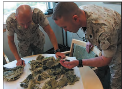
Фрагменти шолома з композитного матеріалу кевлар, використаного в бою для захисту від гранати. Ірак. 2004 р.
