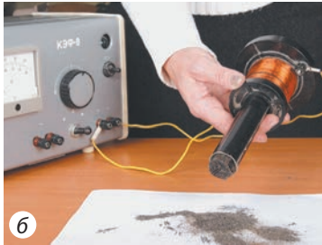
Рис. 6.4. Після замикання кола залізні ошурки притягуються до осердя (а); після розмикання кола — відпадають від нього (б)
