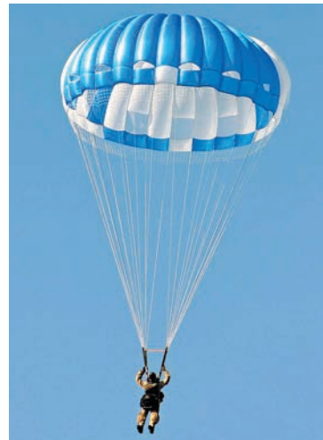
Рис. 30.2. Парашутист деякий час може рухатися рівномірно прямолінійно, коли дія Землі буде зрівноважена дією повітря та строп парашута
