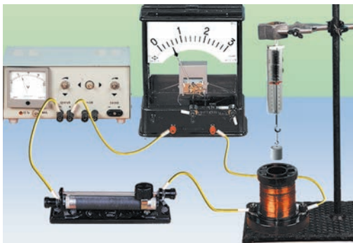
Рис. 6.1. Дослідження магнітної дії котушки зі струмом
